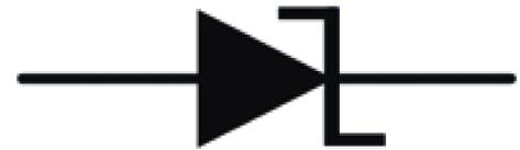
El diodo Zener se comporta como un diodo normal al estar polarizado directamente, y comienza a conducir, aproximadamente, a una tensión de 0,7 V.
