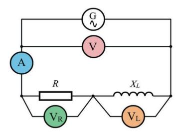
La combinación de los efectos limitadores de la corriente producidos por la resistencia y la bobina recibe el nombre de impedancia y se representa por la letra Z.
