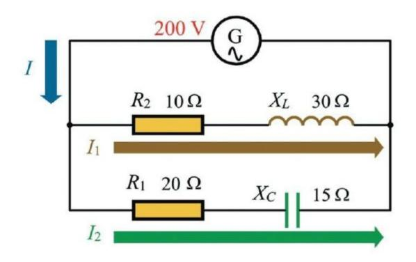
Para resolver este circuito, en el diagrama vectorial, se toma como referencia la tensión U en común con las dos ramas y se calculan por separado las intensidades de cada circuito derivado.
