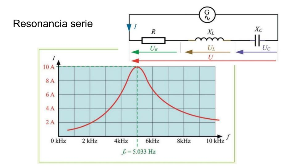
Un circuito está formado por una resistencia de 10  $\Omega$ , una bobina de 1 mH y un condensador de 1  $\mu$ F.
