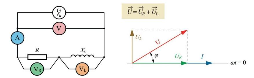
En un circuito R-L la corriente queda retrasada un ángulo o respecto de la tensión, que ya no es 90° como en el caso de la bobina pura. El valor de este ángulo dependerá de los valores de la resistencia respecto de la bobina.
