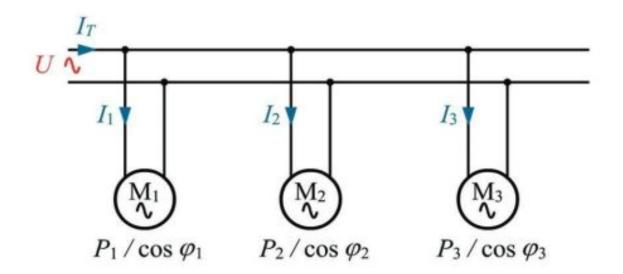
Para resolver estos circuitos basta con averiguar la potencia activa y reactiva de cada uno de los receptores.
