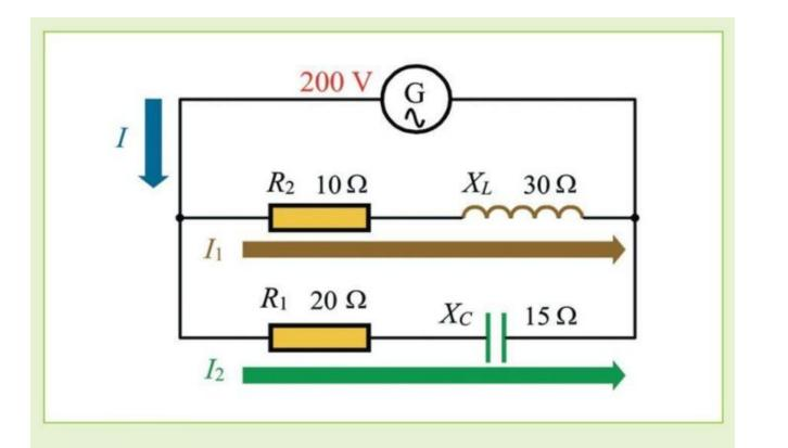
Averigua  $I_T$ ,  $I_1$ ,  $I_2$ ,  $P_T$ ,  $Q_T$ ,  $S_T$ ,  $\cos \varphi_T$  y la lectura de un voltímetro conectado en paralelo con la reactancia  $X_C$ .
