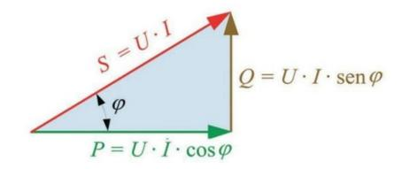
**Potencia activa:** este tipo de potencia es el que se transforma en calor en la resistencia. Se puede decir que es la única potencia que realmente se consume en el circuito y, por tanto, es la que debe aportar el generador al circuito.
