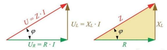
Con el triángulo de impedancias podemos obtener el valor de la impedancia *Z*:
