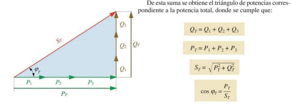
La instalación eléctrica de una nave industrial consta de los siguientes receptores, conectados a una línea monofásica de 400 V, 50 Hz: (1) motor monofásico de 10 kW,  $\cos \varphi = 0.7$ ; (2) 30 lámparas incandescentes de 60 W cada una; (3) 50 lámparas de vapor de mercurio de 200 W,  $\cos \varphi = 0.6$  cada una
