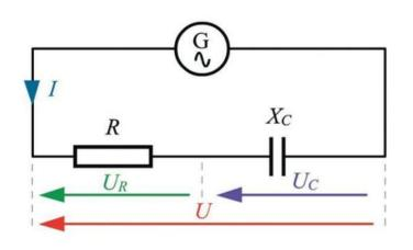
Al igual que ocurría con el circuito R-L, aquí aparece una sola corriente eléctrica *I* que queda limitada por la impedancia del circuito *Z*.
