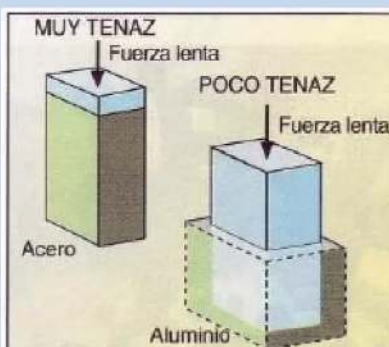
Figura 4.8(g). Tenacidad. Resistencia que opone un cuerpo a su rotura cuando está sometido a esfuerzos lentos de deformación.
