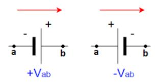
a) Si la intensidad entra por el polo negativo de la pila y sale por el positivo, la fuerza electromotriz de la pila tiene signo positivo. Considerando la resistencia interna de la pila despreciable, la fuerzaelectromotiz coincide con el valor de la tensión de la pila. En esta situación:
