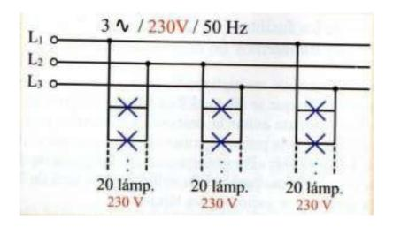
Explica si la conexión para las lámparas de la figura es la correcta. ¿Qué tipo de conexión es?
