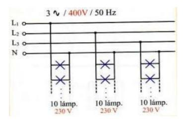
Como la red es trifásica, si conecto 10 lámparas en paralelo entre cada línea y el conductor de neutro, el conjunto de lámparas queda conectado en estrella. Y además como entre cada línea y el neutro ( cada fase ) hay 10 lámparas idénticas el sistema es equilibrado en fases.
