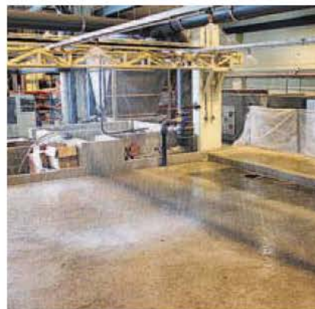
Prueba de lluvia en una calle del laboratorio del Citeec. ANDRÉS LEMOS
