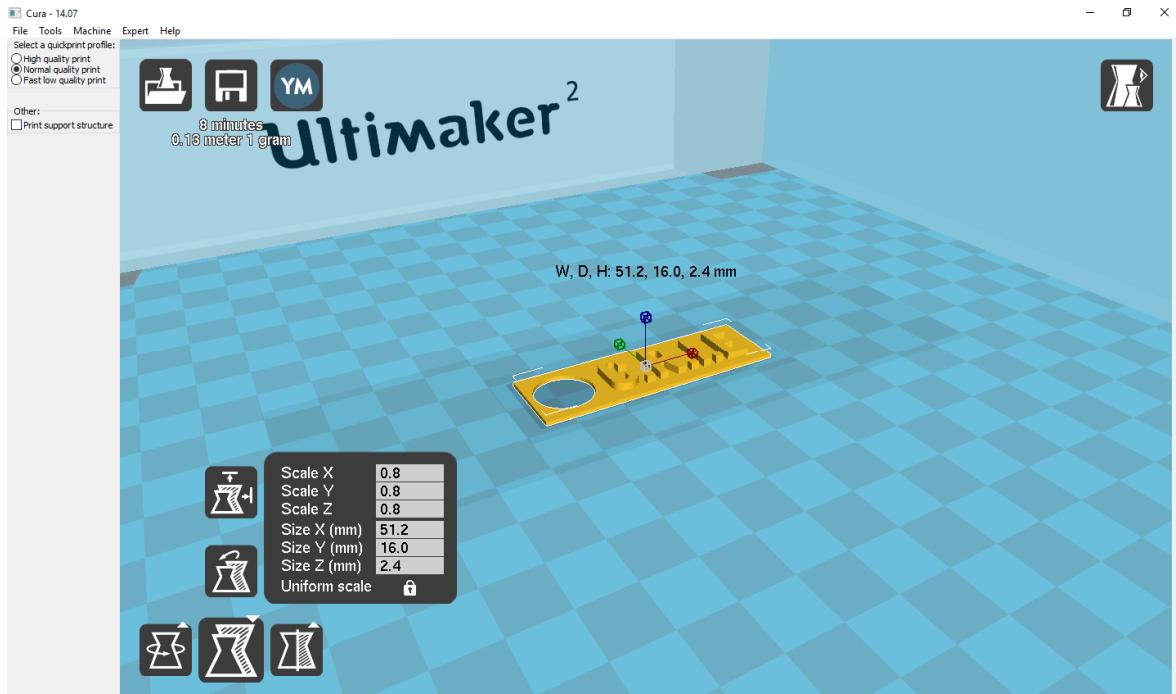
Se pueden escoger distintos parámetros modificando así el tiempo de impresión que originalmente venía dada del programa de diseño **Tinkercad**. Se puede guardar el diseño en el ordenador de este programa igualmente.
