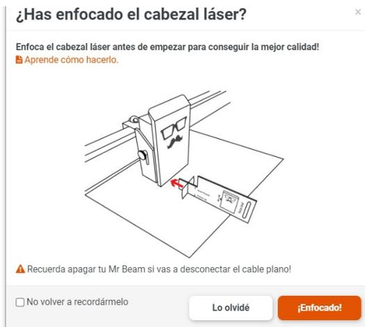
Para enfocarlo debes situar la siguiente pieza de cartón debajo del cabezal y debe entrar y salir sin problema. El cabezal siempre debe estar a una distancia de 1cm del material. Para mover el cabezal afloja el tornillo que tiene a su izquierda (dejar siempre un poco más alto porque cuando se suelta el tornillo siempre baja un poquito)
