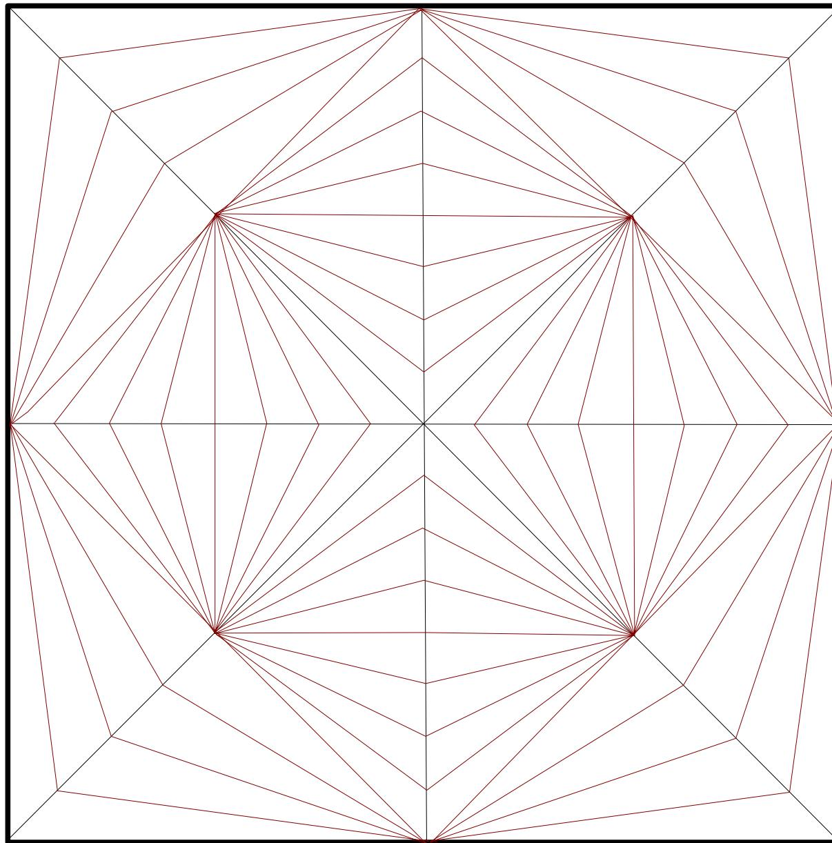
Acabamos el dibujo uniendo las marcas de 5 mm de las diagonales con los puntos Medios de los lados.
