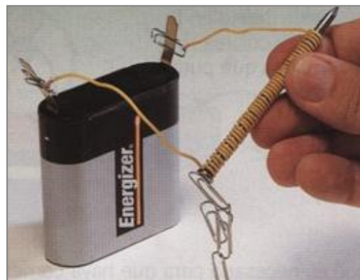
Electroimán: bobina con núcleo de ferro
