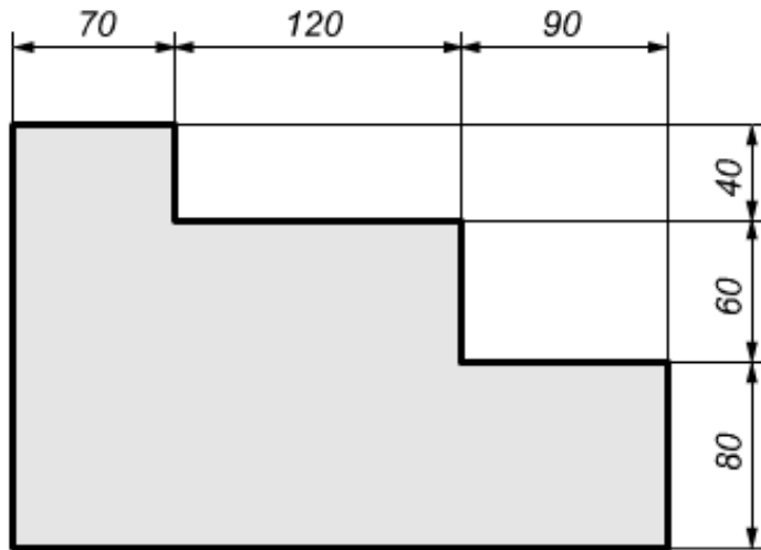
Acotación del dibujo de una pieza escalonada.
