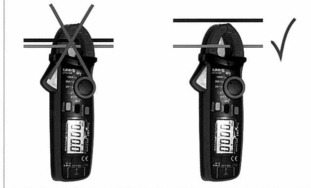
Figura 4.18. Cómo medir intensidad con pinza.
