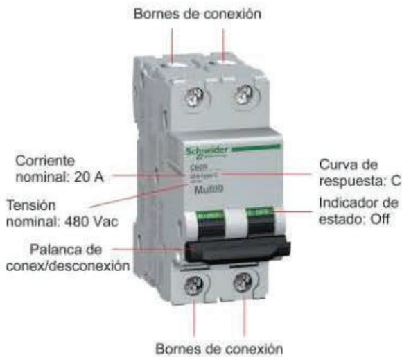
Figura 4.42. Partes del interruptor automático magnetotérmico.
