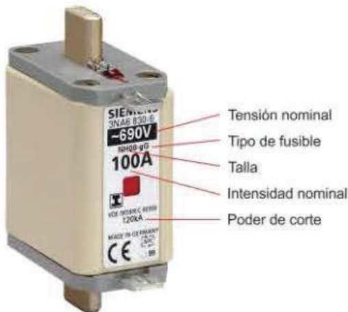
Figura 4.5. Parámetros sobre un fusible.
