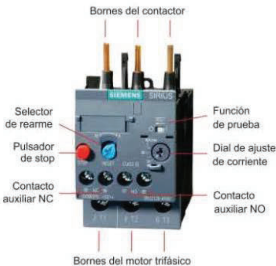
Figura 4.24. Partes del relé térmico.
