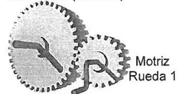
2. Un motor que gira a 100 r.p.m. tiene montado en su eje un engranaje de 60 dientes y está acoplado a otro engranaje de 20 dientes.
