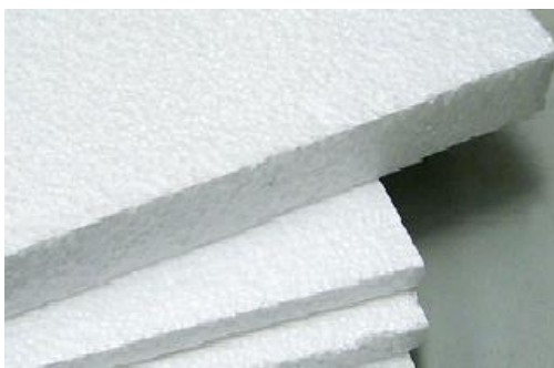
POREXPAN (mal conductor térmico, buen aislante térmico)
