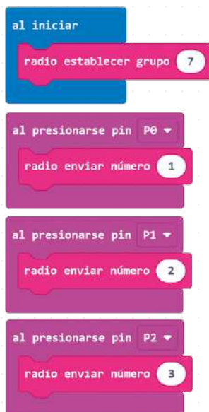
Programa para una Micro:bit con tres teclas conectadas
