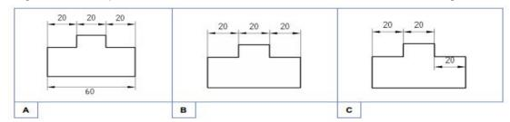
(PA\_CFGM\_2014) Si el alzado de la pieza es el señalado, ¿cuál sería su perfil? Rodea la letra de la figura correcta.
