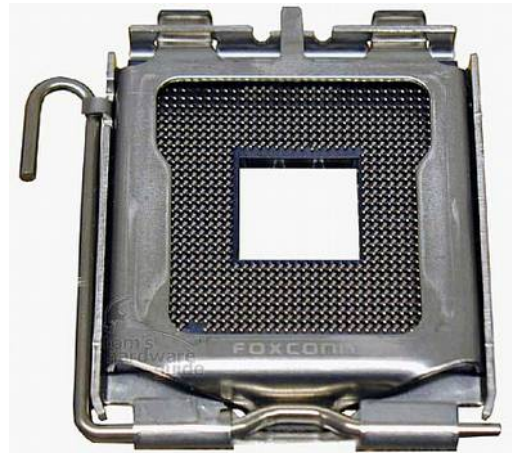
Socket en el que se inserta el microprocesador. .
