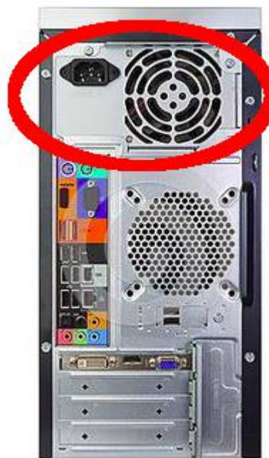
Parte trasera de un ordenador. Enmarcado en rojo, se observa la fuente de alimentación.
