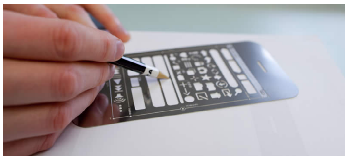
FIG 5.7. Con plantillas metálicas se obtienen formas más definidas que a mano alzada.
