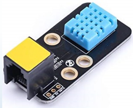
Sensor temperatura e humidade
