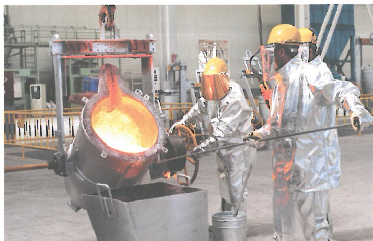
Figura 5.3. Las operaciones industriales de fundición de metales siempre se realizan con altas temperaturas, maquinaria pesada y productos inflamables que requieren especial atención.
