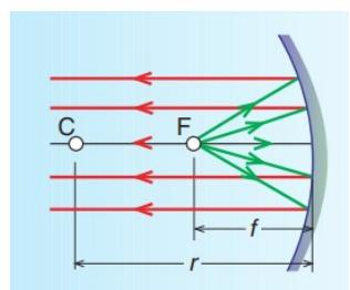
Vemos que en los espejos esféricos la distancia focal objeto coincide con la distancia focal imagen, por lo que se considera una sola distancia focal. Su valor es:  $f' = f = r/2$ . Con este nuevo resultado, la ecuación fundamental de los espejos esféricos escrita en función de la distancia focal es:
