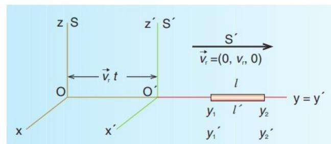
Supongamos una barra en reposo con respecto a sistema de referencia  $S'$  colocada en la dirección del eje  $O'y'$ . La longitud de la barra medida en este sistema de referencia  $S'$  (en el que se encuentra en reposo) se llama longitud propia y vale:  $\Delta y' = y_2' - y_1' = l'$ .
