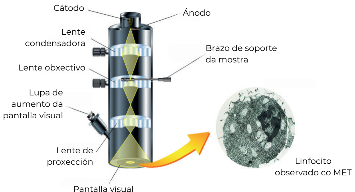
Figura 3. Partes dun microscopio electrónico de transmisión. As sales de metais pesados empregados para darlle contraste ás mostras deposítanse nas estruturas celulares de forma selectiva e impiden o paso dos electróns. Isto fai que as mostras amosen zonas electroclaras e zonas electroescuras. As imaxes obtidas son sempre en branco e negro, aínda que ás veces pódeseles aportar cor mediante un procesamento informático posterior.
