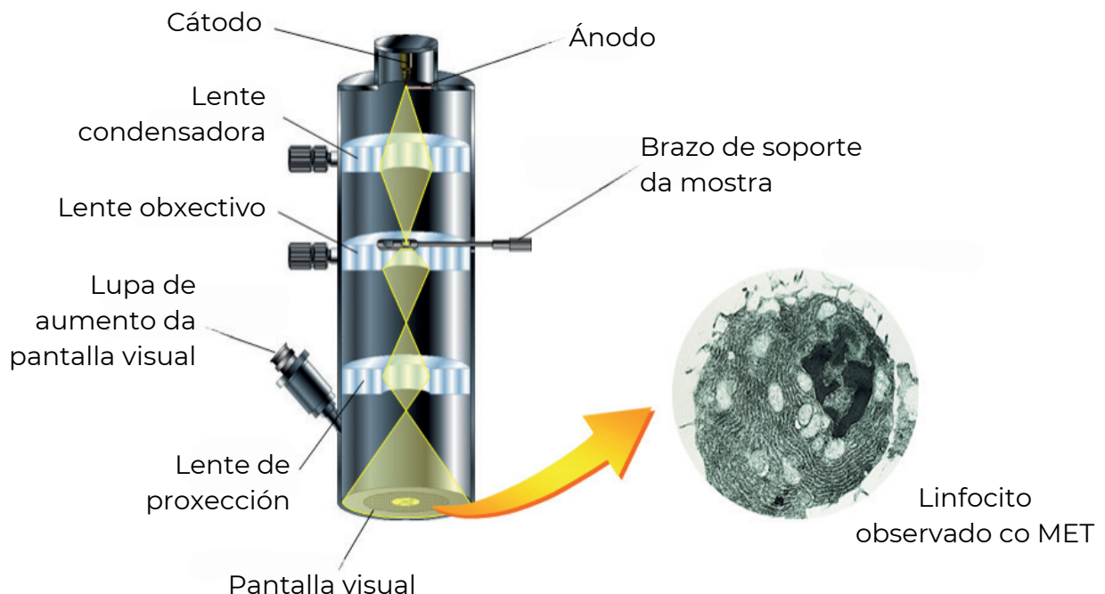
Figura 3. Partes dun microscopio electrónico de transmisión. As sales de metais pesados empregados para darlle contraste ás mostras depóitanse nas estruturas celulares de forma selectiva e impiden o paso dos electróns. Isto fai que as mostras amosen zonas electroclaras e zonas electroescuras. As imaxes obtidas son sempre en branco e negro, aínda que ás veces pódeseles aportar cor mediante un procesamento informático posterior.
