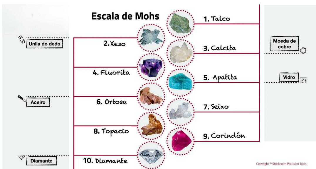
Figura 4. Minerais de referencia empregados na Escala de Mohs xunto con métodos analíticos sinxelos para determinar a dureza aproximada dunha mostra mineral.
