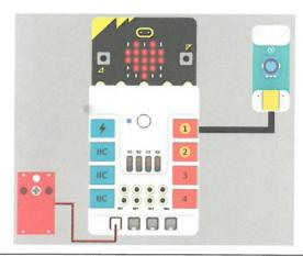
Crea un nuevo proyecto en makecode y agrega las extensiones planetX y Nezha. En un bucle infinito, asignamos al motor una velocidad de movimiento en base al valor que proporciona el potenciómetro.
