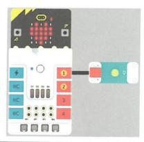
Crea un nuevo proyecto en makecode y agrega las extensiones planetX y Nezha. En un bucle infinito, introducimos un bloque condicional. Si la luz detectada es inferior a 10, enciende el led. Si no, apaga el led.
