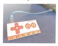
Para comprobar que la placa está funcionando correctamente, colocamos el dedo índice de una mano en la zona conductora llamada "earth" y el dedo índice de la otra mano en la zona conductora denominada "space".
