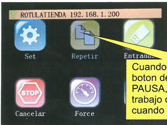
Quando el plotter esta cortando, el boton de repetir se cambiara a PAUSA, donde se puede parar el trabajo cuando se quiera, y seguir cuando se pulse de nuevo.
