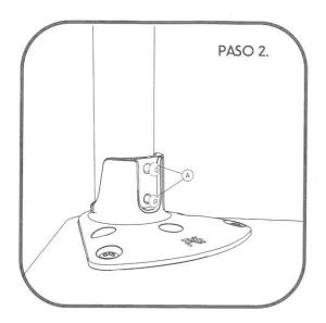
Una vez alineado, introducir los tornillos A y atornillar manualmente hasta que los tornillos se sujeten a la pata.
