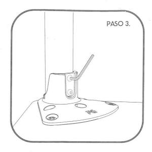
Apretar con llave ó máquina hasta ajustar los tornillos a la pata.
