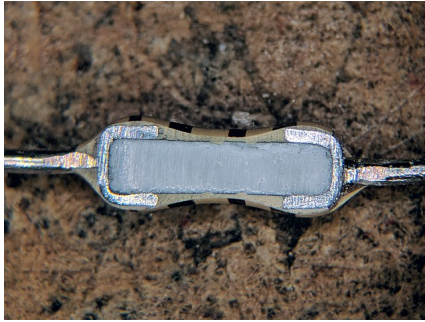
Figura 5: sección de resistor de película de carbono. Imaxe de TubeTimeUS
