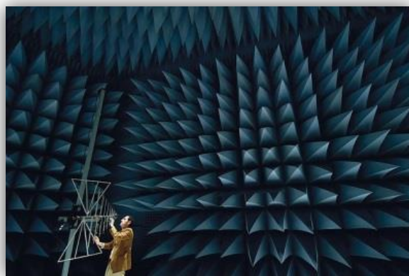
Cámara anecoica deseñada para absorber na súa totalidade as reflexións producidas por ondas acústicas
