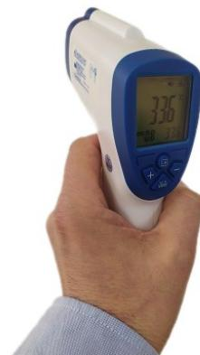
La **temperatura** es la medida del grado de calor o frío de un cuerpo o de un ambiente. La unidad principal para medir la temperatura es el **grado centígrado** (°C). La temperatura la medimos con el **termómetro**.
