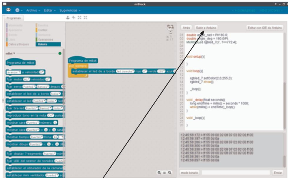
Si pulsamos sobre "**subir a arduino**" el programa se cargará en el robot y éste lo ejecutará de forma autónoma, pudiendo funcionar sin estar conectado al PC.
