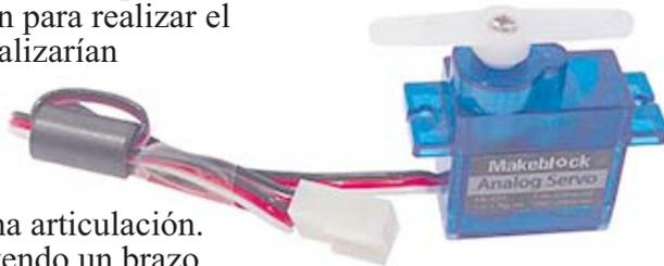
Son utilizados para movimientos de más precisión como sería el movimiento de una articulación. Así por ejemplo si estuviésemos construyendo un brazo, el movimiento de un codo podría controlarse con un servomotor.
