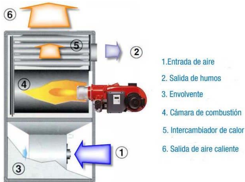
Fig. 19: Generador de aire caliente.
