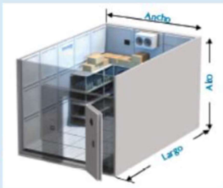
Figura 6.7 Dimensiones de una cámara frigorífica. (Fuente: Danfoss).
