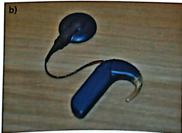
Fig. 4.8. Audífono (a) e implante coclear (b).
