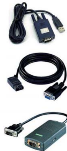
↑ Figura 9.26. Diferentes modelos de cables y adaptadores RS232 y USB/RS485 para la programación de Autómatas a través de PC (SIEMENS AG).
