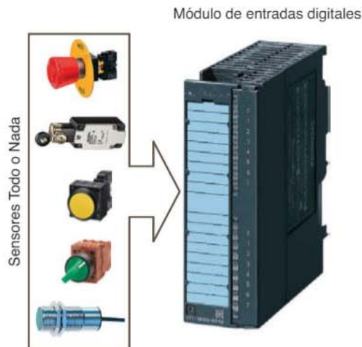
↑ Figura 9.11. Módulo de entradas de un S7-300 de Siemens y diferentes sensores que se pueden conectar a él.
