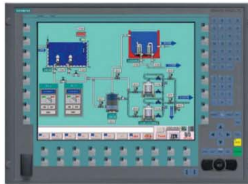
↑ Figura 9.31. Panel de operación gráfico (SIEMENS).
