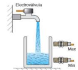
↑ Figura 5.31. Ejemplo de aplicación para el control de llenado y vaciado de un depósito con detectores capacitivos.
