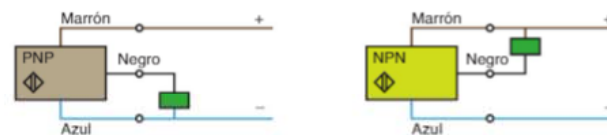
↑ Figura 5.36. Esquemas de conexión de sensores PNP y NPN.
