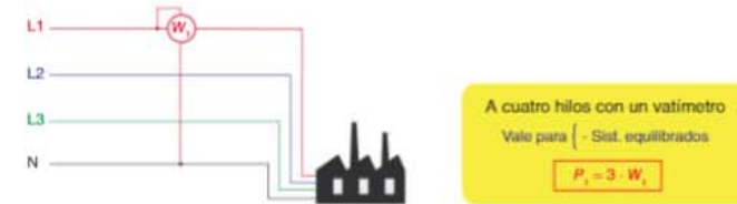
Figura 5.19. Medida a cuatro hilos con un vatímetro.
