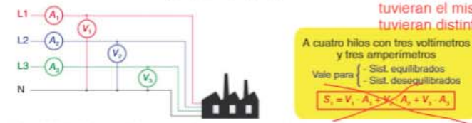
Figura 5.20. Medida a cuatro hilos con tres voltímetros y tres amperímetros.
