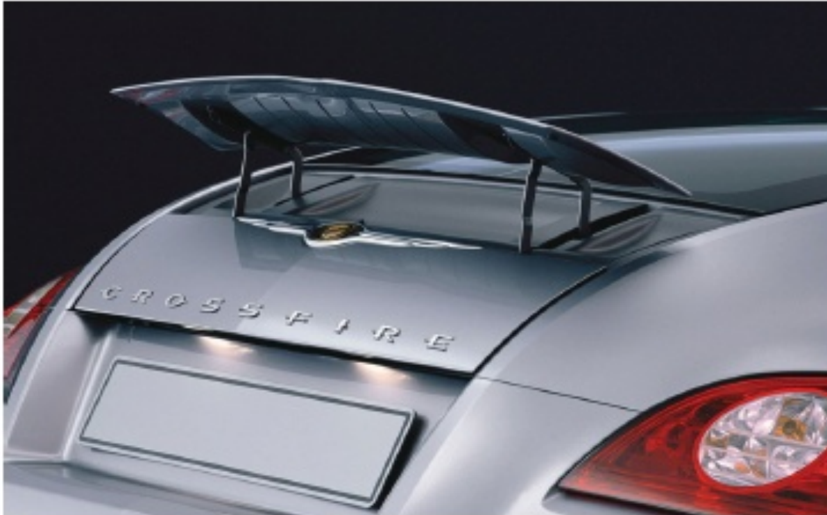
Figura 2.39. Spoiler con regulación automática de despliegue.
