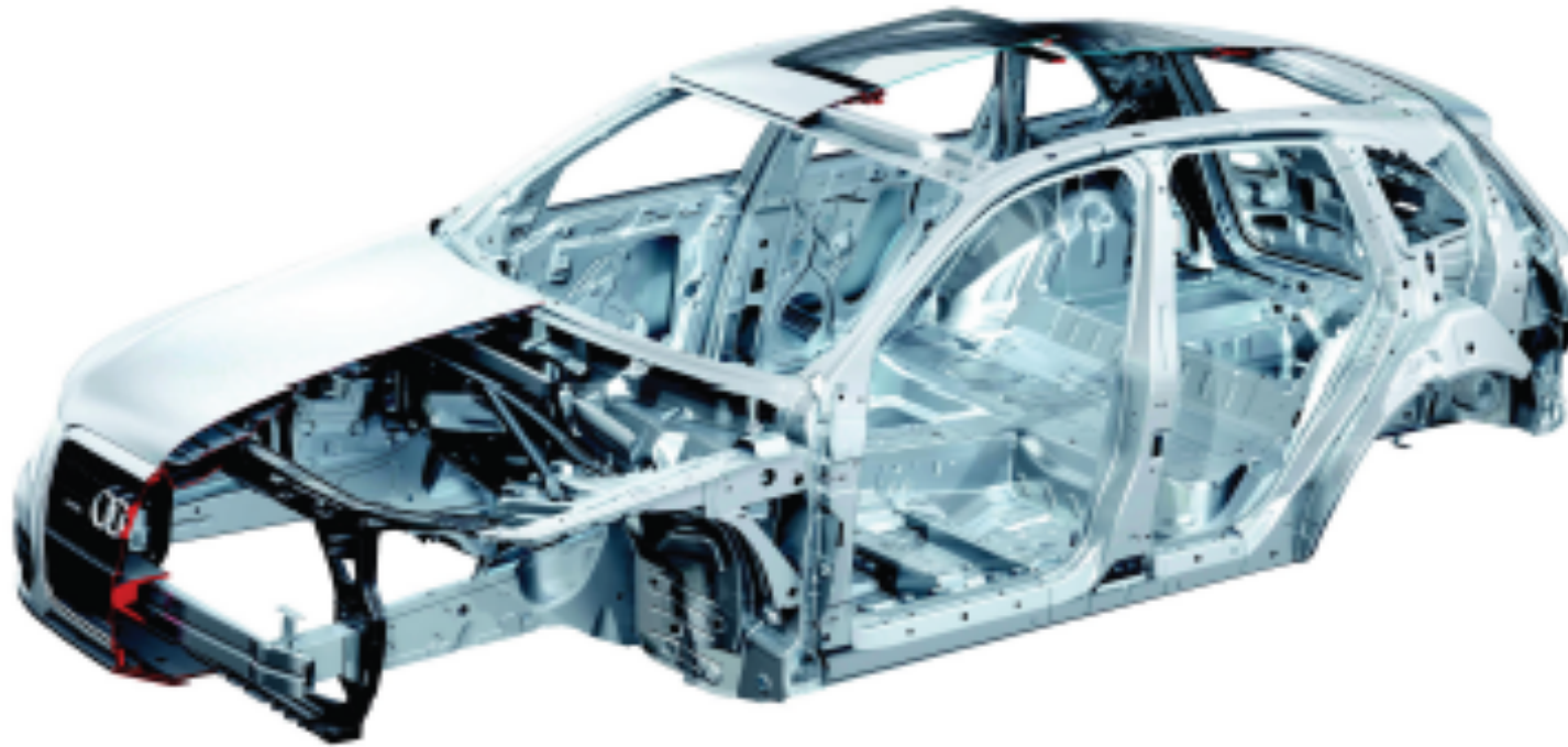
Figura 2.1. Estructura de una carrocería autoportante.
