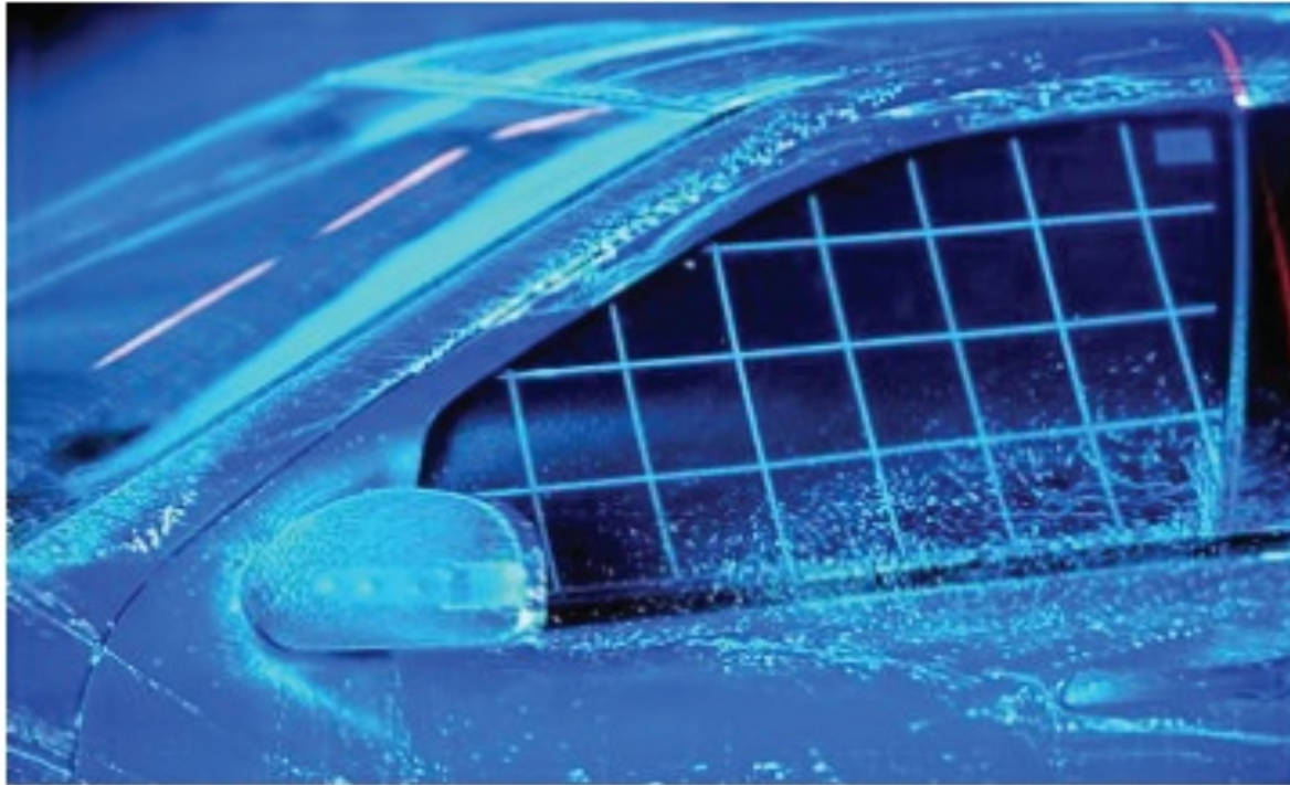
Figura 2.46. Test de evacuación del agua de lluvia.
