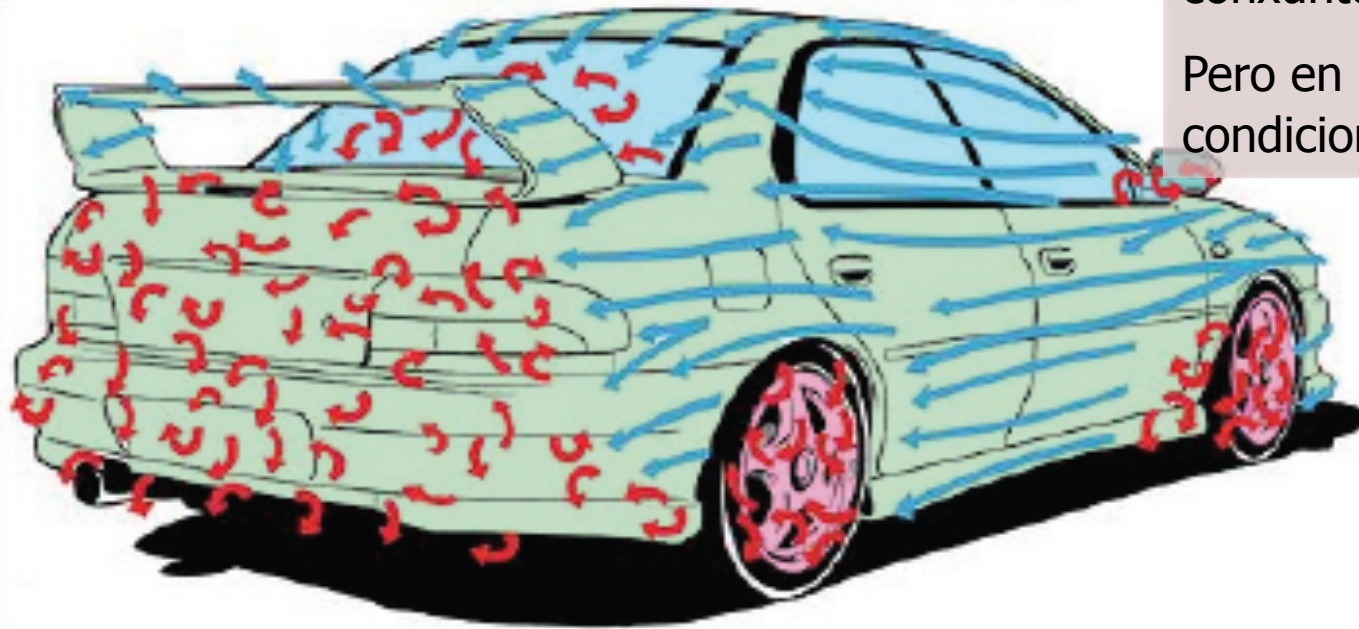
Figura 2.33. Turbulencias que generan los componentes exteriores del vehículo.
