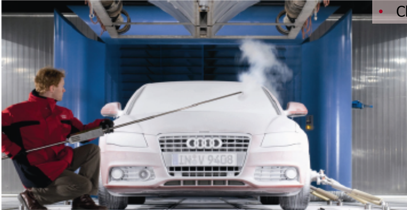
Figura 2.58. Ensayos en un túnel de viento climático.
