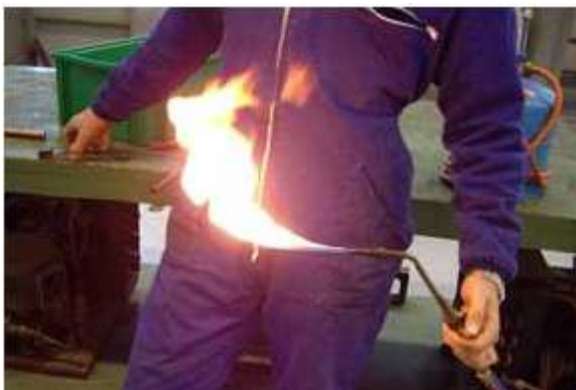
Fig. 41: Encendido de la llama sin la intervención del oxígeno.
