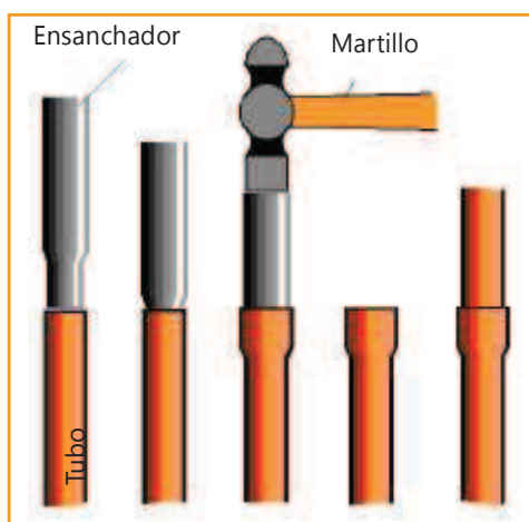
Fig. 54: Secuencia de ensanchado con un ensanchador de golpe y posterior unión de tubos.
