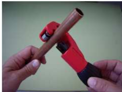
Fig. 27: Corte de tubo de cobre con cortatubos
