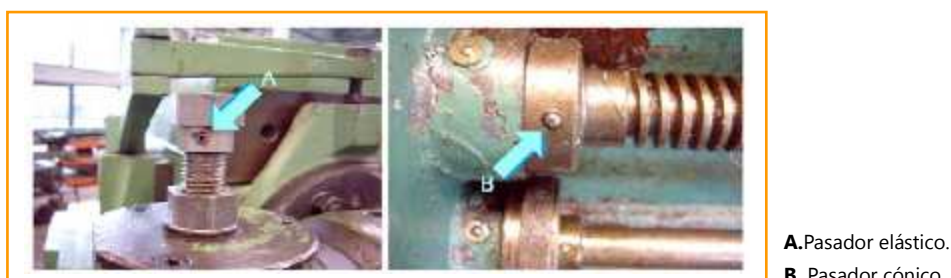
Fig. 61: Pasadores instalados en máquinas-herramientas.
