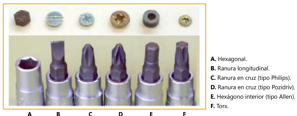
Fig. 23: Herramientas de apriete correspondientes a las diferentes cabezas y ranuras.
