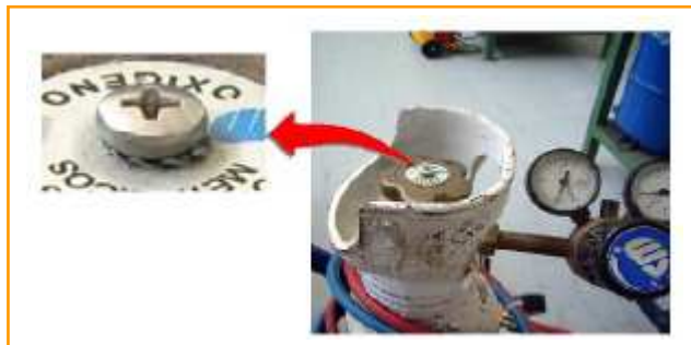
Fig. 50: Uso de una arandela dentada en el grifo de una botella de oxígeno.
