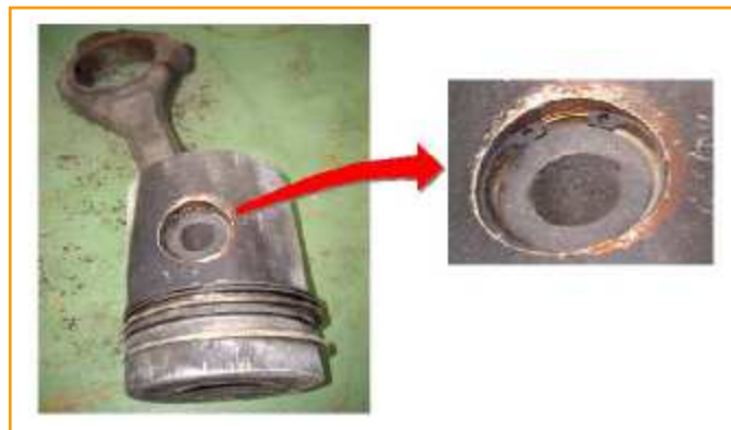
Fig. 57: Aplicación de un anillo elástico a la retención de un bulón de un pistón.
