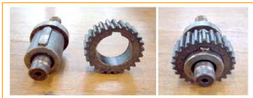
Fig. 65: Unión de una rueda dentada en un eje mediante chaveta.
