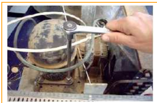
Fig. 31: Llave de vaso con alargadera.
