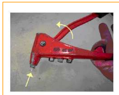
Fig. 70: Introducción del remache en la boquilla.
