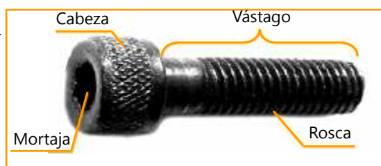
Fig. 1: Partes principales de un tornillo.
