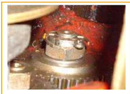
Fig. 48: Tuerca almenada con pasador de aletas instalada en la caja de velocidades de un torno.
