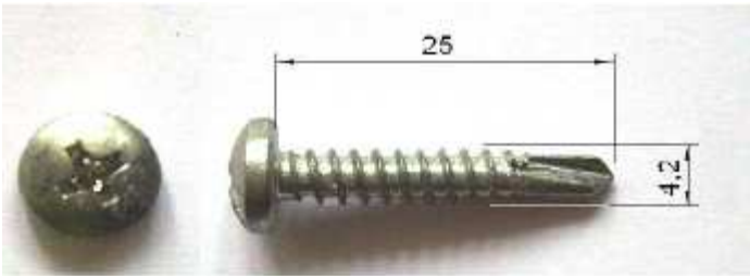
Tornillo para chapa autotaladrante de cabeza alomada con mortaja en cruz, diámetro 4,2 x 25, cincado.
