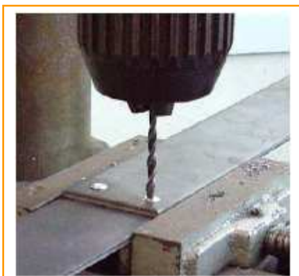
Fig. 72: Eliminación de un remache mediante taladrado.
