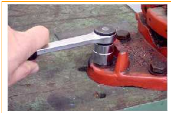
Fig. 30: Llave de vaso accionada con mango de carraca.
