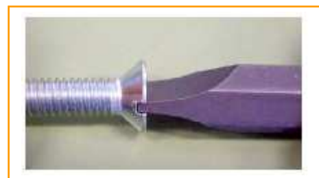
Fig. 36: Detalle del ajuste del extremo del destornillador en la ranura del tornillo.
