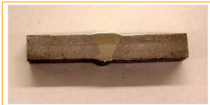
Fig. 5: Dos piezas unidas mediante soldadura homogénea.
