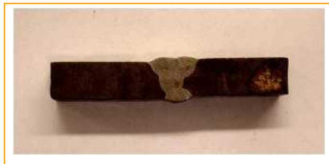
Fig. 3: Dos piezas unidas mediante soldadura heterogénea.
