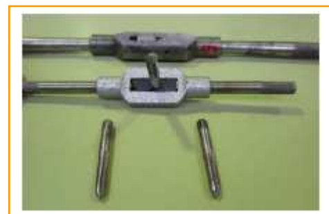
Fig. 36: Machos de roscar y giramachos.
