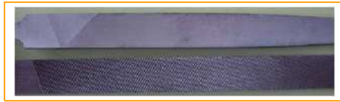
Fig. 4 : Picado de una lima fina (arriba) y una basta (abajo).
