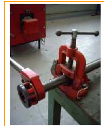
Fig. 40: Mecanizado manual de una rosca.
