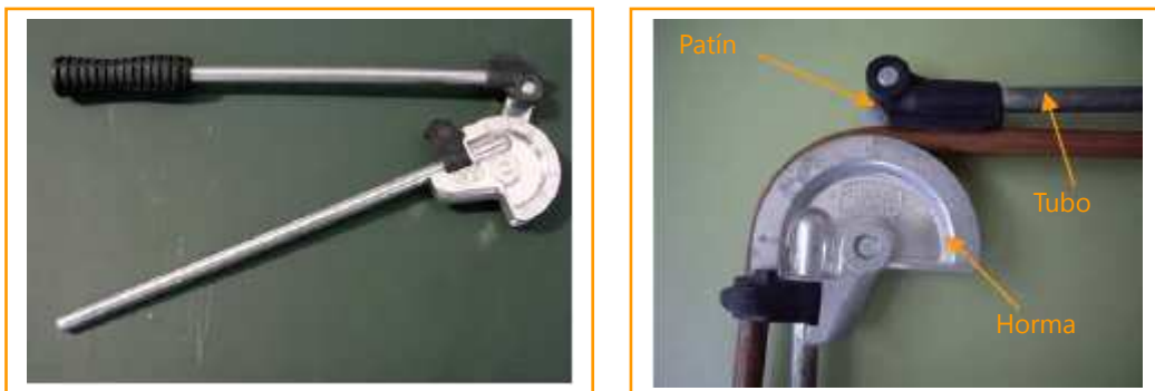
Fig. 49: Curvadora de tubos manual y detalle de doblado
