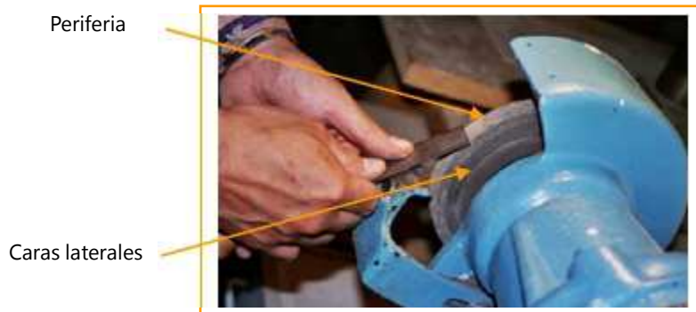
Fig. 8 : Afilado de una herramienta en la esmeriladora.
