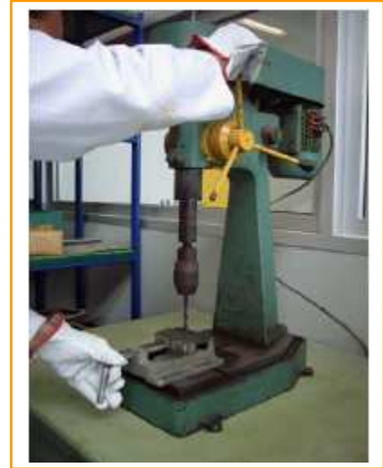
Fig. 24 : Forma correcta de sujetar la mordaza durante el taladrado.
