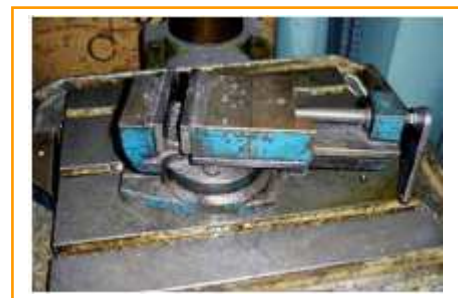
Fig. 12: Mordaza para sujetar las piezas que se van a taladrar.
