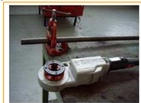
Fig. 41: Máquina para roscar tubos. Observa la terraja colocada.
