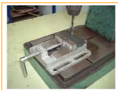
Fig. 21: Sujeción de la pieza en la mordaza para el taladrado.
