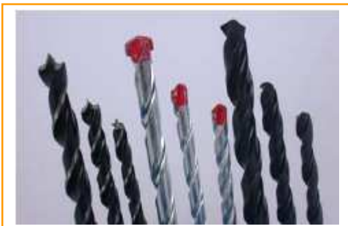
Fig. 16 : Brocas para madera, pared y acero.
