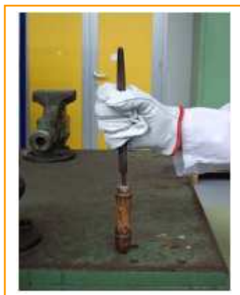
Fig. 6 : Modo correcto de colocar el mango en la lima.
