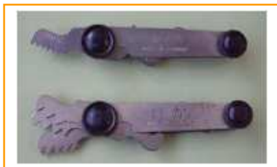
Fig. 32: Peines o galgas para la comprobación del paso de las roscas.
