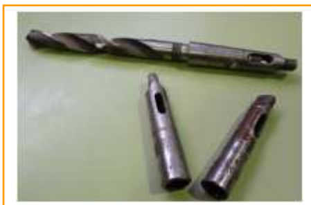
Fig. 14 : Brocas de mango cónico y casquillos adaptadores.
