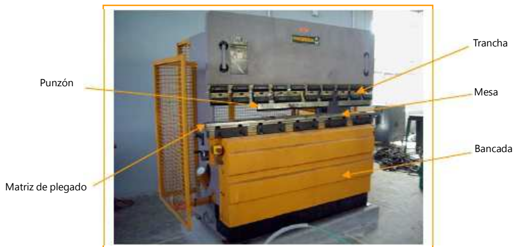
Fig. 42: Plegadora automática de chapa.
