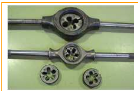
Fig. 34: Terrajas y portaterrajas para la fabricación de roscas exteriores.
