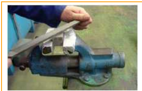
Fig. 5 : Técnicas del limado.
