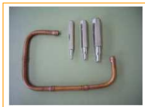
Fig. 53: Ensanchadores de golpe y tubos unidos mediante expansión.
