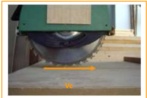
Fig. 19 : Velocidad de corte en una sierra circular.
