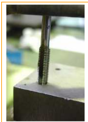
Fig. 38: Inicio del roscado de un agujero.
