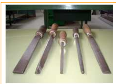
Fig. 2 : Distintas formas de limas.
