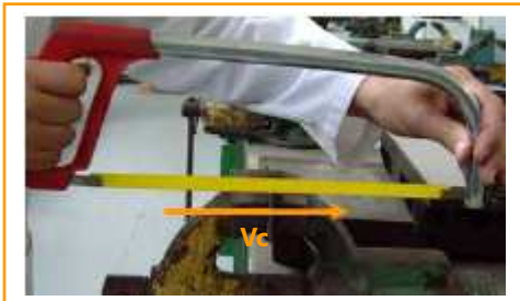
Fig. 18 : Velocidad de corte en una sierra de mano.
