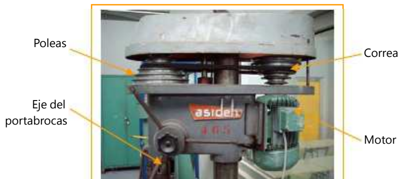
Fig. 11: Cabezal de una taladradora de mesa en el que se aprecian las poleas y la correa de la caja de velocidades.
