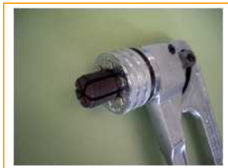
Fig. 51: Expandidor de tubos y detalle de boquilla expandida.
