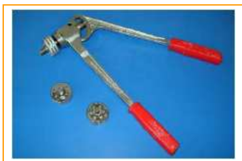
Fig. 51: Expandidor de tubos y detalle de boquilla expandida.
