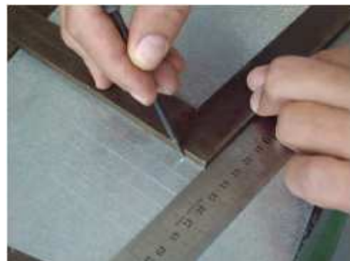
Fig. 6: Trazado de perpendiculares a una línea oblicua con regla y escuadra simple
