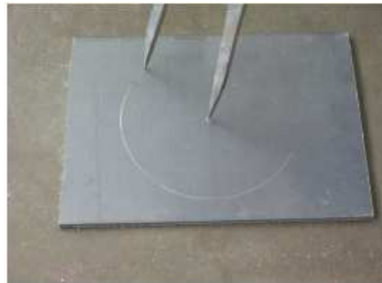
Fig. 12: Trazado de una circunferencia con compás
