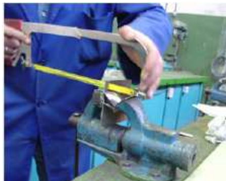
Fig. 34: Operación de serrado
