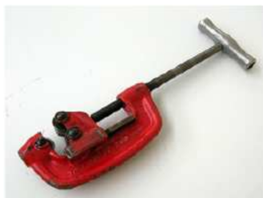
Fig. 26: Cortatubos para acero
