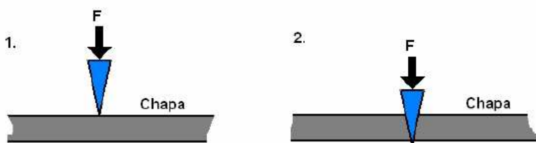
Figura 17. Corte de una chapa por penetración
