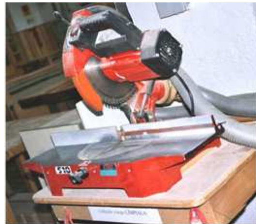
Fig. 31: Sierra circular o de disco
