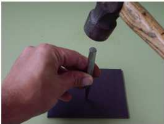
Fig. 11: Marcado del centro de la circunferencia con granete y martillo
