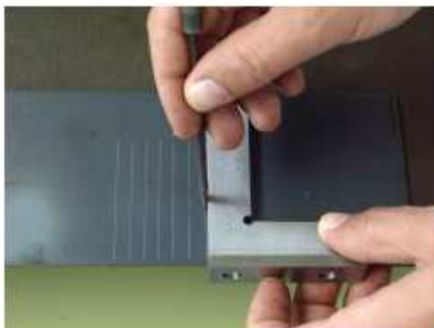
Fig. 5: Trazado de perpendiculares al borde de la pieza con escuadra de solapa
