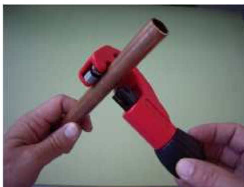
Fig. 27: Corte de tubo de cobre con cortatubos
