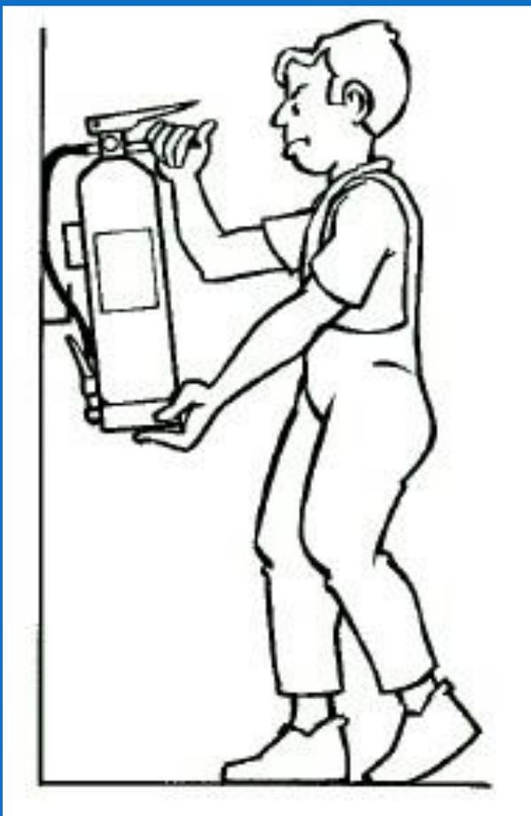
1. Descolgar el extintor asiéndolo por la maneta o asa fija y dejarlo sobre el suelo en posición vertical.
