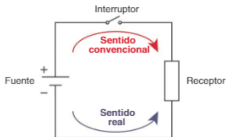
Figura 1.17. Sentido convencional y real de la corriente.
